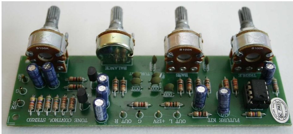
รูปที่ 2 แสดงการประกอบวงจรโทน-คอนโทรล สเตอริโอ (FK626)
